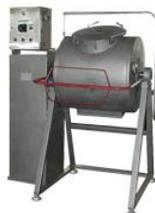
**Назначение:** - производство масла сливочного методом периодического сбивания.
