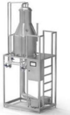
Сырое молоко содержит в среднем до 6% растворенных различных газов. При производстве молочных продуктов они удаляются из молока путем вакуумной деаэрации. Для этого молоко подают в деаэрационную установку, в которой оно очищается от газовых примесей, включая посторонние запахи.
