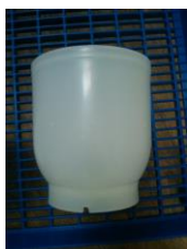
Формы шарообразные полимерные для салфеточного прессования сыра типа "Эдам" и "Голландский" на массу головки 0,4-0,5; 1,0 и 1,8-2,5 кг размерами D 80; 100 и 140 мм соответственно. Состоят из формы и крышки, имеющими отверстия для отвода сыворотки.
